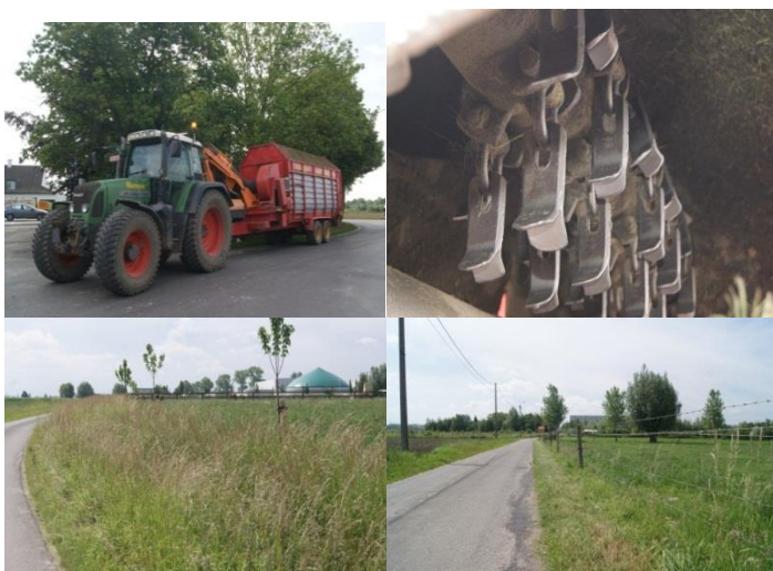
Figuur 2: (In klokwijzerzin) Maai-zuigcombinatie, Y-klepels, berm na afloop van maaien, berm voorafgaand aan maaien.
